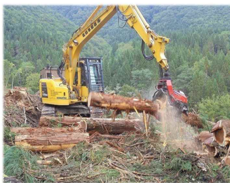
高性能林業機械による丸太の造材作業
