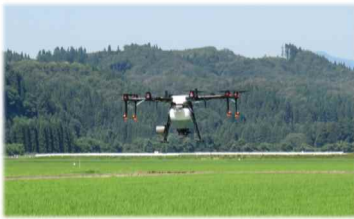
ドローンによる農業散布
